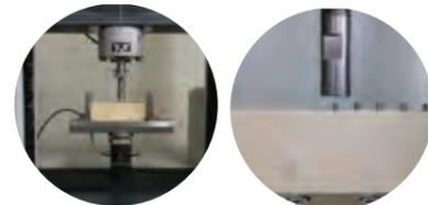
sem Versuch ist es uns gelungen, ein spezielles provisorisches Abutment mit niedriger Bruchfestigkeit von unter 200 N (20,4 kg) zu entwickeln, das wir Fuse Abutment nennen. Ein zusätzlicher Vorteil ist das anatomische Profil, das zu einer ansprechenden Ästhetik auch bei Provisorien beiträgt.
