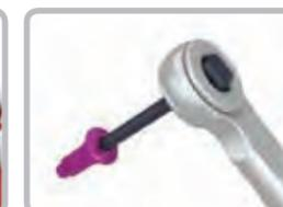
Befestigen sie das ausgedrehte Objekt in einem Schraubstock. Drehen sie das Objekt im Uhrzeigersinn um es wieder von dem Hex Remover zu trennen.
