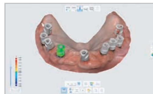
Abutments und Scanbodies werden automatisch mit den Scandaten abgeglichen und erkannt.
