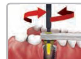
Drücken Sie den Schraubenentferner nach unten, während Sie diesen gegen den Uhrzeigersinn drehen. Damit lösen Sie die fakturierte Abutmentschraube aus dem innenliegenden Gewindes des Implantats. (U/min: 30-50, Drehmoment: 30Ncm)
