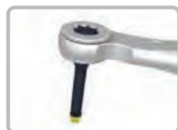
Sichern Sie die getrennte Schnapp-Kupplung in einem Schraubstock oder einer Schraubstockzange. Verwenden Sie den Ratschenschlüssel, indem sie gegen den Uhrzeigersinn drehen um das Abutment und den Abutment Ausdreher zu trennen.
